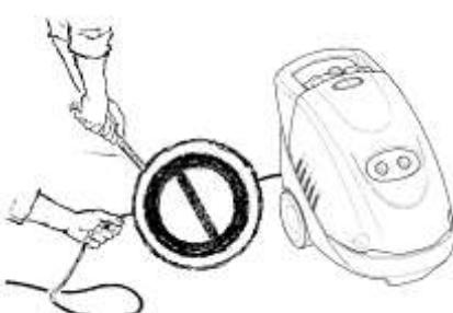
Non utilizzare il cavo di alimentazione o i tubi di collegamento per la movimentazione della macchina.
