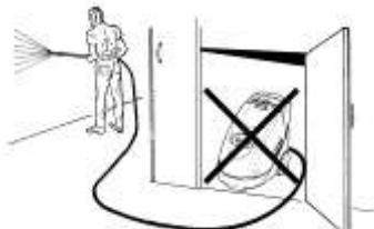
No utilizar la máquina en ambientes cerrados o donde hay insuficiente ventilación.
