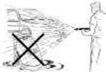
È vietato rivolgere il getto d'acqua contro la pompa e contro ogni altra parte sotto tensione elettrica. Può provocare danni elettrici e pericolo per l'operatore.
