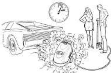
No hacer marchar la máquina por más de 5 minutos con la pistola cerrada. Más allá de dicho límite, la bomba se sobrecalienta con mucho daño para ella misma y peligro para el usuario. (Sólo para máquinas sin Totalstop).
