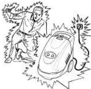
Antes de efectuar cualquier intervención en el aparato, se debe desconectar la clavija del enchufe. Cada intervención técnica deberá ser efectuada absolutamente en un centro técnico autorizado.
