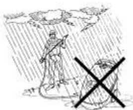
Mettre la machine à l'abri des intempéries. Eviter d'utiliser la machine sous la pluie, durant un orage ou lorsque de l'eau ou des liquides divers sont susceptibles d'atteindre les parties électriques.
