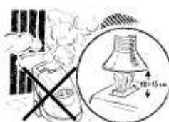
Es ist eine Vorrichtung zur Abgasung der Verbrennungsgase in die freie Luft einzurichten. Die Abgasung in geschlossene Räume ist höchst gefährlich!
