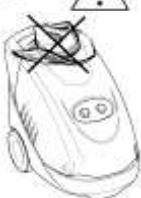
Non ostruire il terminale del camino di uscita dei fumi della caldaia.
