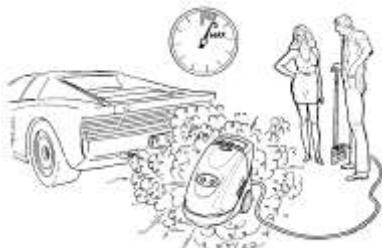
Ne jamais laisser la machine en service plus de 5 minutes avec le pistolet fermé. Ceci risque de gravement endommager la pompe - par surchauffe - et constitue un risque pour la sécurité de l'opérateur. (Seulement pour machines sans Totalstop).
