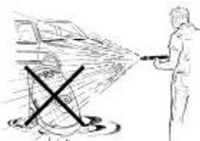
Es ist verboten, den Wasserstrahl gegen die Pumpe oder andere spannungsführende Teile zu richten.
