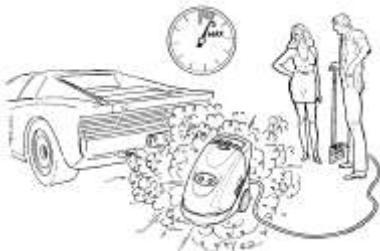
Die Maschine nicht länger als 5 Minuten mit geschlossener Pistole laufen lassen. Danach wird die Pumpe so stark überheizt, daß sie schwer beschädigt würde und auch Gefahr für den Bediener besteht. (Nur für Maschinen ohne Totalstop).
