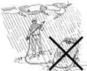
Proteger la máquina de los agentes atmosféricos. No utilizar la hidrolimpiadora con la lluvia o tormentas ni en ninguna otra situación en que agua u otros líquidos puedan mojar las partes eléctricas.
