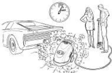
Non lasciare in funzione la macchina per più di 5 minuti con la pistola chiusa. Oltre tale limite la pompa si surriscalda con gravi danni per la stessa e pericolo per l'operatore. (Solo per macchine senza Total Stop).
