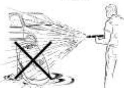
Se prohíbe dirigir el chorro de agua contra la bomba y cualquier parte que esté bajo tensión. Eso puede causar daños eléctricos y ser peligroso para el usuario.
