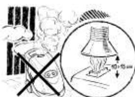
Prévoir un dispositif d'échappement à l'air libre des gaz de combustion.
