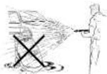
Il est interdit de diriger le jet d'eau en direction de la pompe ou de toute autre partie sous tension. Ceci présente un risque pour la sécurité de l'opérateur et peut endommager le circuit électrique.
