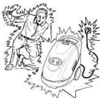
Avant d'effectuer toute intervention sur la machine, débrancher impérativement la prise d'alimentation électrique. Toute intervention technique devra être formellement exécutée auprès d'un centre technique autorisé.
