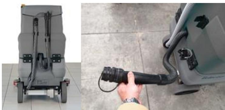
Tubo de descarga del agua sucia con control del flujo (flow control)
