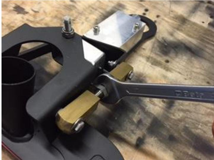
2. altura desde el suelo: con la tuerca de apriete de la rueda de apoyo en el suelo, para mover en sentido vertical la misma rueda, enroscándola o desenroscándola de su chapa de fijación.
