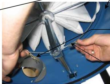
Quitar el perno (A) y la clavija (B) que bloquean el filtro a la palanca de sacudimiento en la parte baja de la cámara filtrante.
