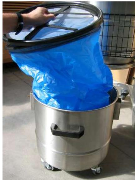
En caso de polvos toxicas o explosivas, es necesario utilizar el extractor al efecto, para que se evite el contacto directo con los desechos. Poner el saco en un contenedor de recogida por residuos especiales y destinarlo a la eliminación según la ley vigente en el País de utilización del aspirador.
