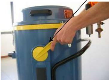
Girar las dos palancas laterales en sentido horario por debloquear el contenedor extraíble del MTL 352 DS air.
